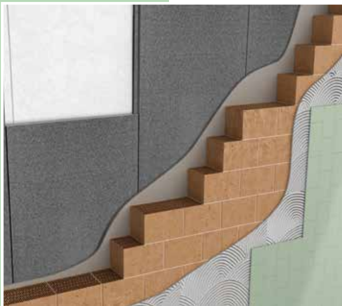
Isolamento in controplaccaggio su parete in laterizio
