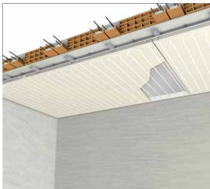
Isolamento interno su soffitto con sistemi di riscaldamento e raffrescamento
