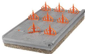
Sistema termoisolante acustico brevettato, composto da un pannello in polistirene espanso sinterizzato additivato di grafite, Neopor® di BASF, stampato con bordi perimetrali ad incastro, munito di sistemi di ancoraggio mediante perni in polipropilene, ideale per la posa e il fissaggio di coppi forati. Il pannello è accoppiato, nel lato inferiore, a lastra in fibrocemento di 50 mm di spessore che garantisce ottime performance d'isolamento acustico e di sfasamento termico del manto di copertura.
