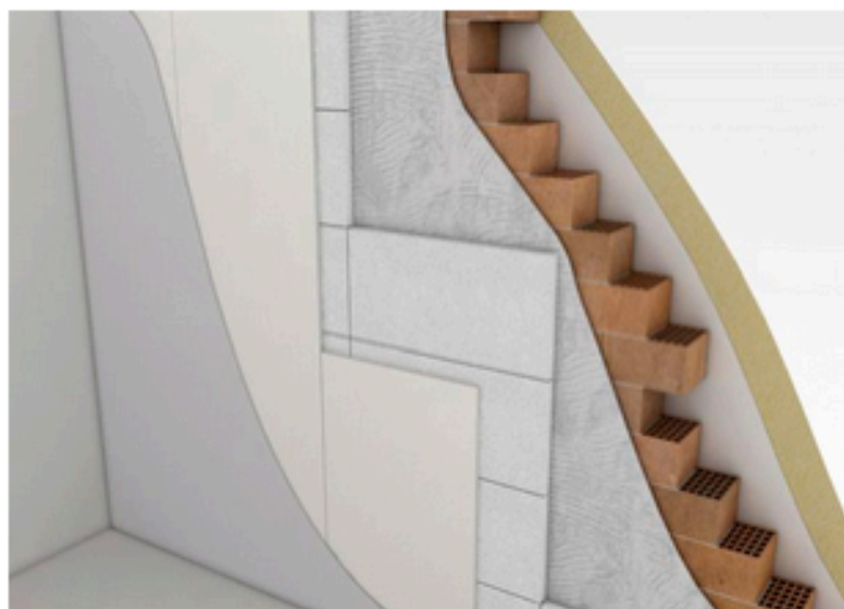
Isolconfort | Applicazione di Eco-espanso 100 per l'isolamento in controplaccaggio delle pareti verticali
