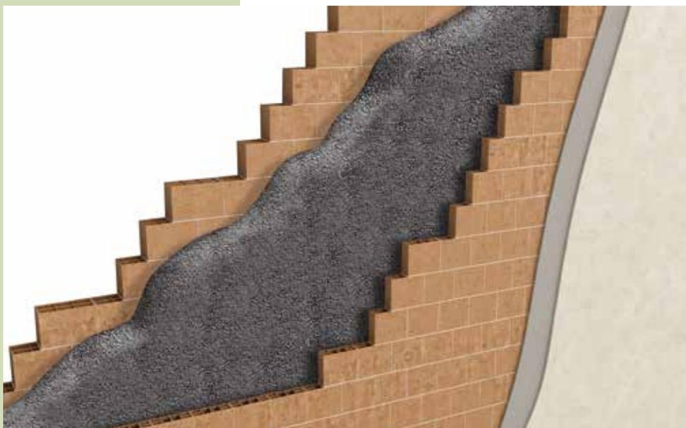
Isolamento mediante insufflaggio
