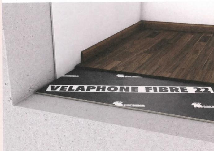
Isolante acustico anticalpestio per sottopavimenti; proposto per un'ampia gamma di applicazioni, è un multistrato in rotoli, ad alte prestazioni antiacustiche, costituito da uno strato di non tessuto in fibra di poliestere, accoppiato a strato bituminoso, con una cimosa longitudinale di sormonto autoadesiva. Presenta non solo ottimi livelli di isolamento acustico anticalpestio, ma anche alta resistenza alla pedonabilità e allo strappo; è impu-tescibile, facile da tagliare e mettere in opera.
