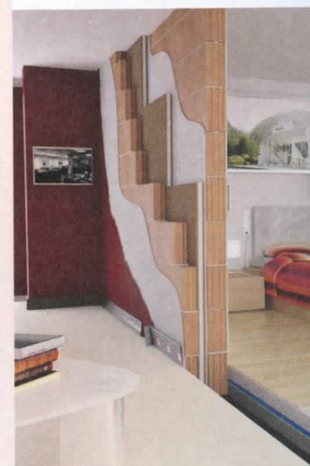
Gamma di isolanti acustici dalle solanti, prodotti dal riciclo di m riciclabili al 100%, in grado di so o i lattici finora utilizzati. La ser materassino anticalpestio da so spessore estremamente ridotto, o laminati; Sonarwood TXT pan stato di fibra di legno e interpos Gispline TXT, per migliorare l'is esistenti in laterizio; Silentetto T rumore nei tetti con struttura in
