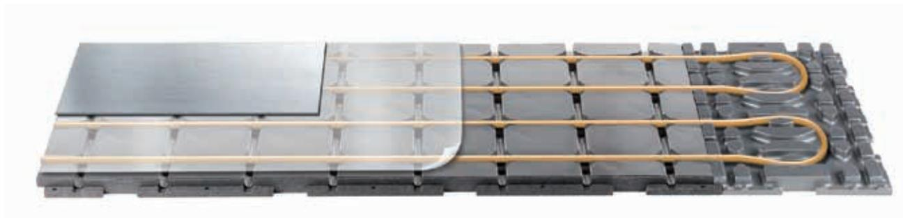
Radial Alu G è il sistema radiante a secco, a pavimento ribassato, per la climatizzazione invernale ed estiva degli ambienti, composto da pannelli in EPS realizzati in Neopor® di BASF accoppiati a fogli di alluminio, ideale in ambito di ristrutturazioni di edifici civili.
