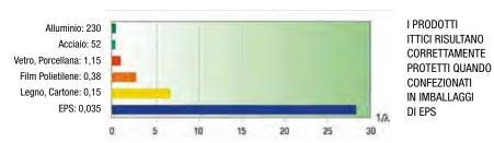
Potere isolante di alcuni materiali espresso dall'inverso dei loro coefficienti di conduttività termica  $1/\lambda$  in (m.k)W ( $\lambda$  è il valore indicato per ogni materiale)
