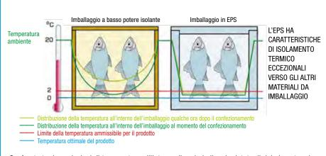
Confronto tra le evoluzioni di temperatura all'interno di un imballaggio dotato di debole potere isolante con quelle all'interno di un packaging in polistirene espanso
