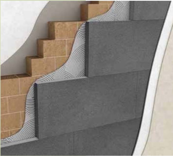
Isolamento a cappotto su parete in laterizio
