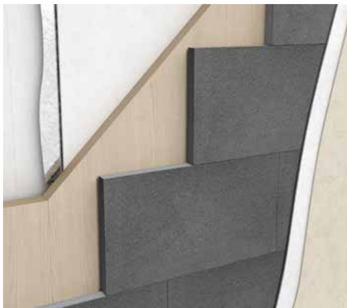
Isolamento a cappotto su parete in legno
