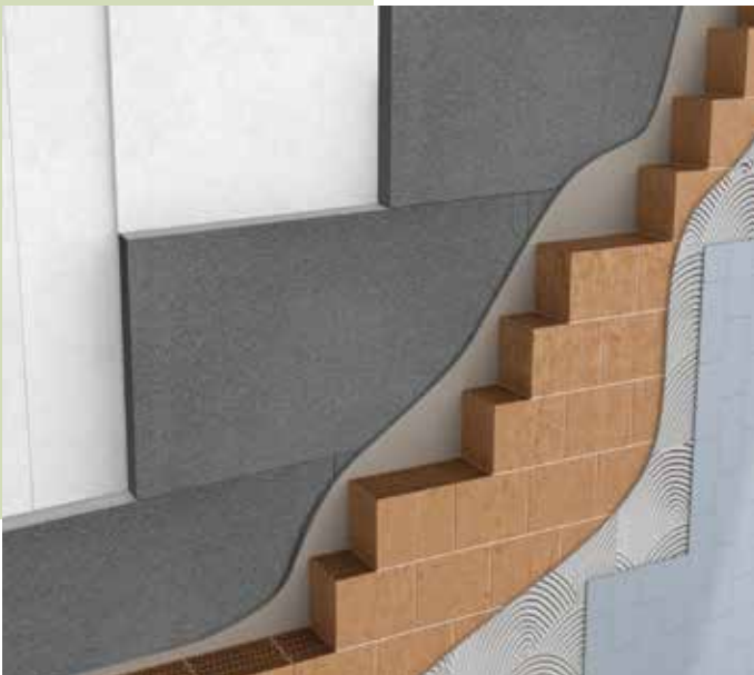
Isolamento in controplaccaggio su parete in laterizio
