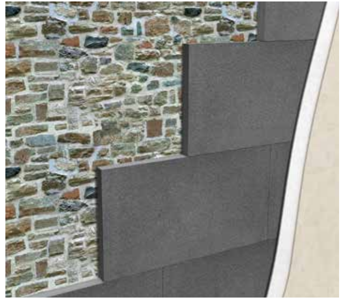
Isolamento a cappotto su parete in pietra
