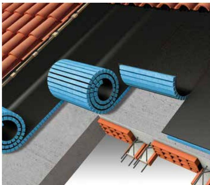
Isolamento per copertura a falda inclinata con struttura in latero-cemento
