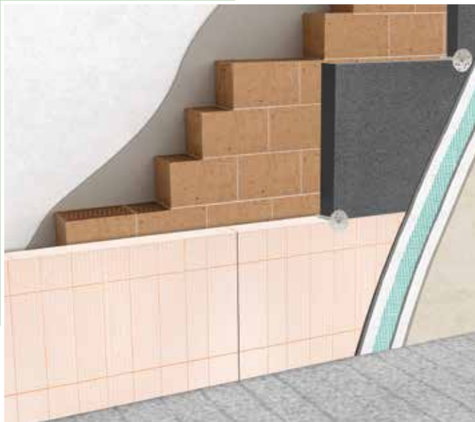
Isolamento a cappotto su parete in laterizio
