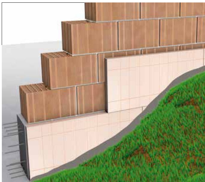
Isolamento del perimetro e dei muri controterra
