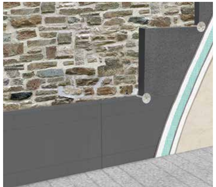
Isolamento a cappotto su parete in pietra
