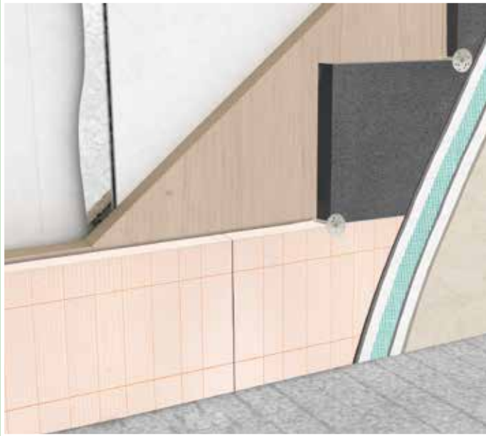
Isolamento a cappotto su parete in legno
