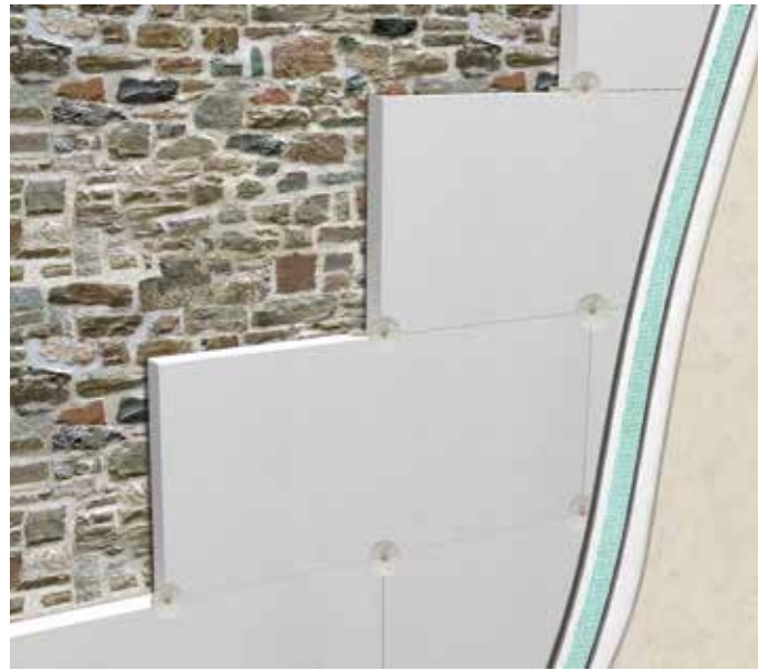
Isolamento a cappotto su parete in pietra
