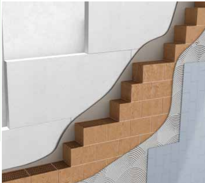
Isolamento in controplaccaggio su parete in laterizio
