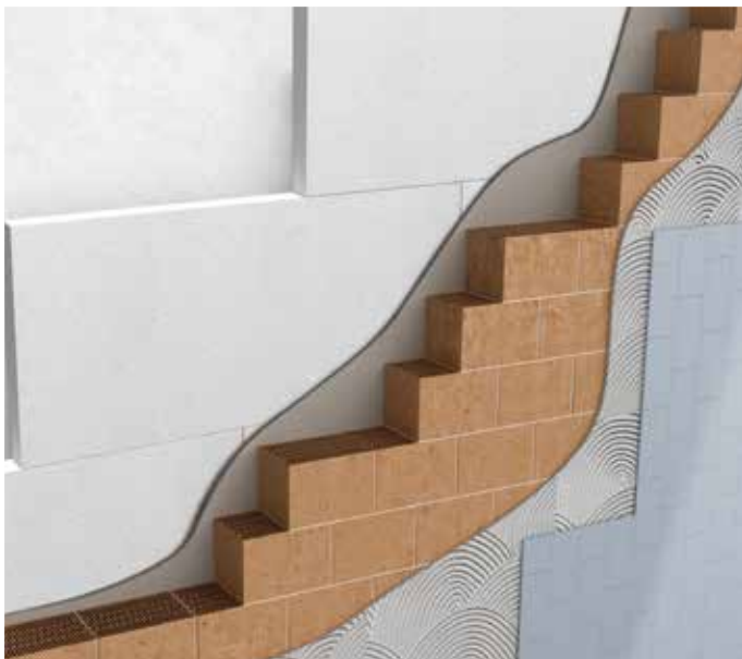
Isolamento in controplaccaggio su parete in laterizio
