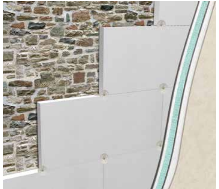
Isolamento a cappotto su parete in pietra
