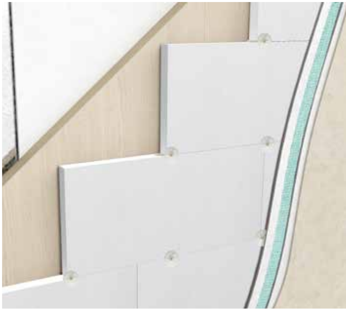
Isolamento a cappotto su parete in legno
