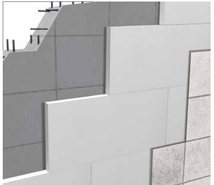
Isolamento in facciata ventilata su parete in calcestruzzo
