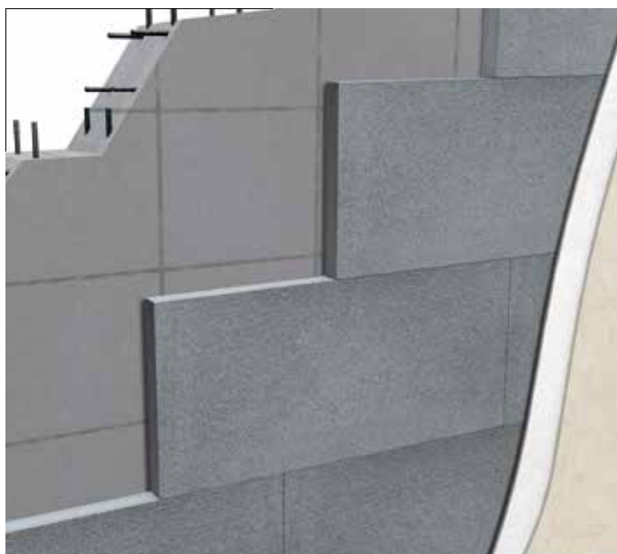
Isolamento a cappotto su parete in calcestruzzo
