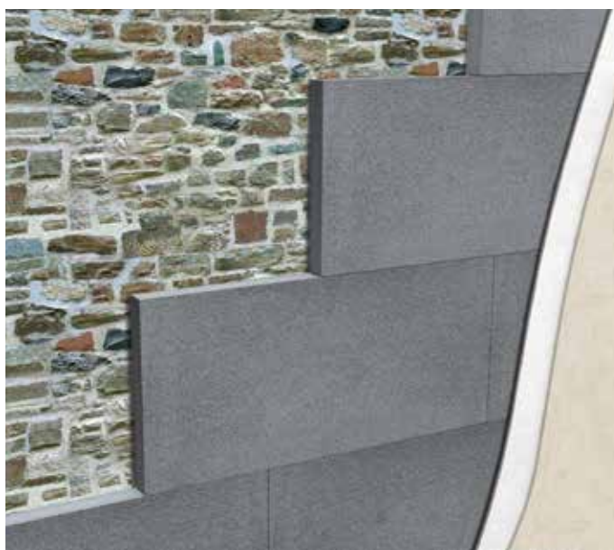
Isolamento a cappotto su parete in pietra
