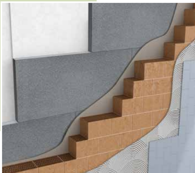
Isolamento in controplaccaggio su parete in laterizio
