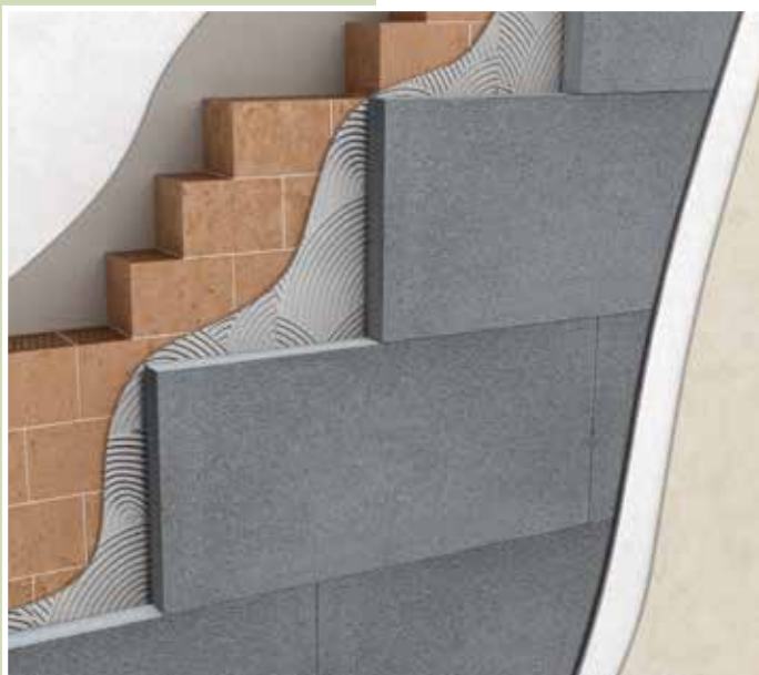
Isolamento a cappotto su parete in laterizio
