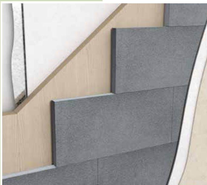
Isolamento a cappotto su parete in legno
