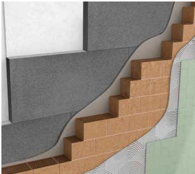
Isolamento in controplaccaggio su parete in laterizio
