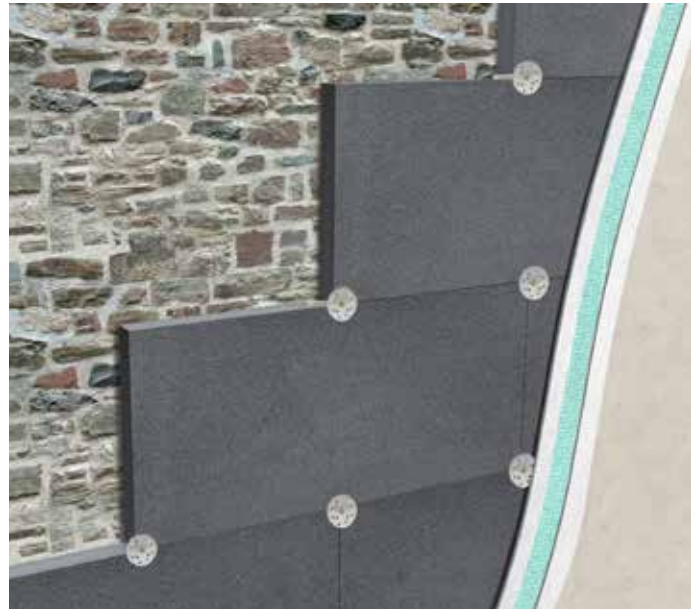
Isolamento a cappotto su parete in pietra
