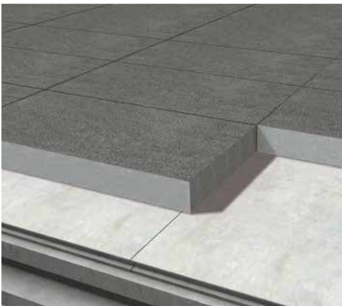
Isolamento per copertura piana con struttura prefabbricata in c.a.
