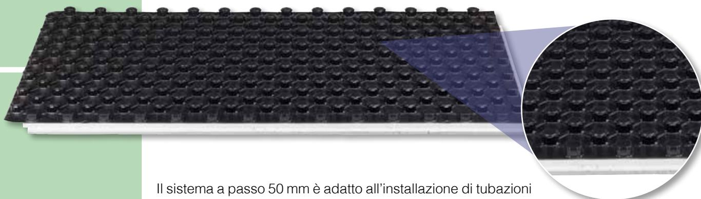
Il sistema a passo 50 mm è adatto all'installazione di tubazioni da 15 a 17 mm di diametro, i pannelli sono stati studiati infatti per poter utilizzare diametri diversi fra loro, dando al sistema una enorme versatilità. Questo sistema conferisce la massima funzionalità: la posa è facile e rapida e garantisce all'installatore minimi dispendi di tempo nel montaggio.
