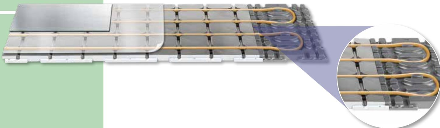
Il sistema radiante è composto da due elementi, **RADIAL ALU PANNELLO** e **RADIAL ALU TESTA**. I pannelli stampati in EPS sono appositamente sagomati e rivestiti da un foglio di alluminio che garantisce l'uniforme diffusione del calore verso l'alto. **RADIAL ALU** possiede bassissima inerzia termica, dovuta all'assenza del massetto cementizio, caratteristica che permette di portare l'ambiente alla temperatura desiderata in tempi molto brevi rispetto ai sistemi radianti tradizionali a umido.
