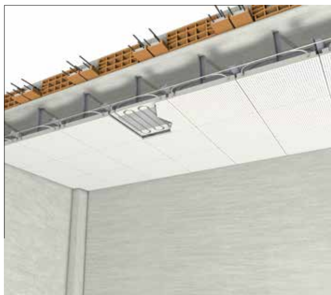
Isolamento interno su controsoffitto con sistemi di riscaldamento e raffrescamento
