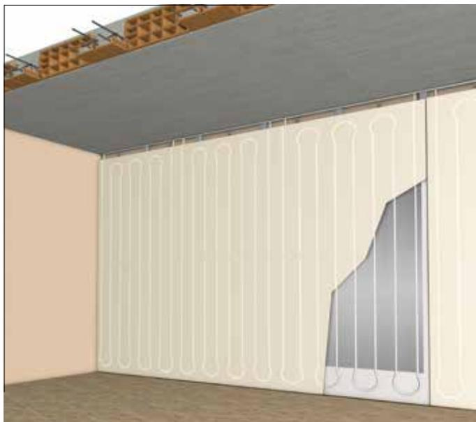
Isolamento in controplaccaggio su parete con sistemi di riscaldamento e raffrescamento
