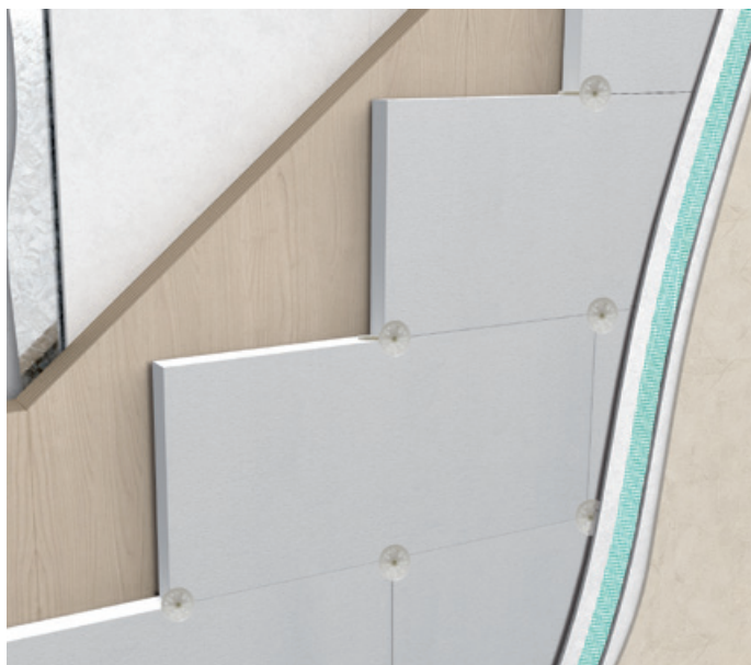
Isolamento a cappotto su parete in legno
