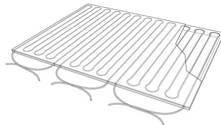
Campi d'applicazione: ideale per sistemi di riscaldamento e raffrescamento su pareti verticali in ambito civile.
