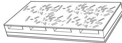
Campi d'applicazione: isolamento termico-acustico ventilato di coperture a falda inclinata.
