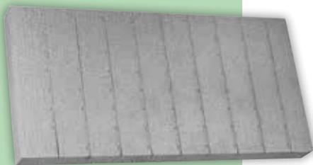
Pannello in polistirene espanso sinterizzato additivato di grafite, Neopor® di BASF, stampato a bordo dritto, con superficie esterna ed interna gofrata per un migliore aggrappaggio e pre-tagli all'estradosso per garantire un'ottima stabilità dimensionale.
