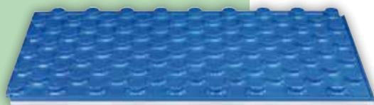
Pannello termoisolante in polistirene espanso sinterizzato, stampato con bugne di 25 mm di spessore a passo 75 mm, idoneo per tubazioni da 20-23 mm di diametro, realizzato con bordi perimetrali ad incastro e rivestito da film termoplastico blu avente funzione di barriera al vapore.
