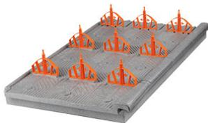
Sistema termoisolante brevettato, composto da un pannello in polistirene espanso sinterizzato additivato di grafite, Neopor® di BASF, stampato con bordi perimetrali ad incastro, munito di sistemi di ancoraggio mediante perni in polipropilene, ideale per la posa e il fissaggio di coppi forati.
